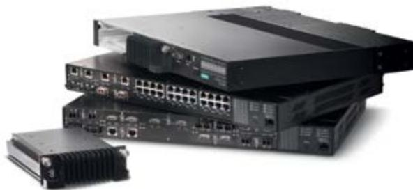
L2 коммутаторы RUGGEDCOM для монтажа в 19'стойку
